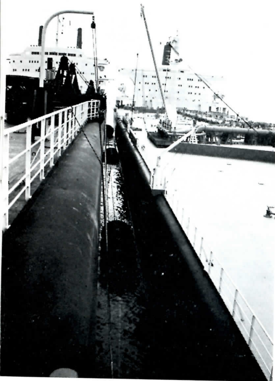
De beide schepen gemeerd met de fenders ertussen; de voorste twee zijn rolfenders, de achterste is een walvisfender.
