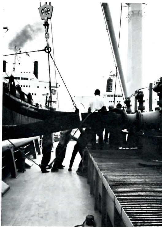
Het aankoppelen der slangen
