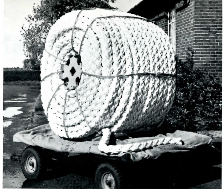
9" nylon tros met een lengte van 420 meter
